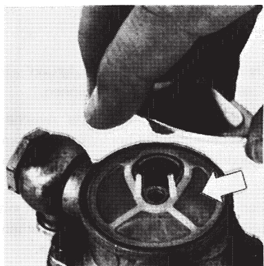
Abb. 21. Förderpumpe mit Vorfilter
